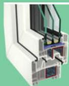
System **CONCEPTTOP** – das neue Mitteldichtungssystem mit stabilem Steg im Fensterfalz. Der Mitteldichtungssteg schützt die mechanischen Teile am Fenster effektiv vor äußeren Einflüssen und sorgt somit für zusätzlichen Einbruchschutz.
